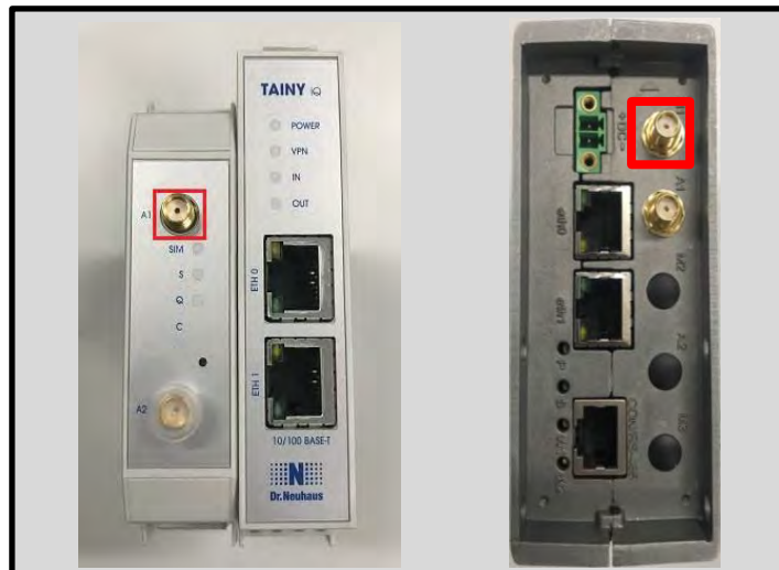
Abbildung 5: Router-Varianten "TAINY" (links) und "Garderos" (rechts) Antennenbelegung
