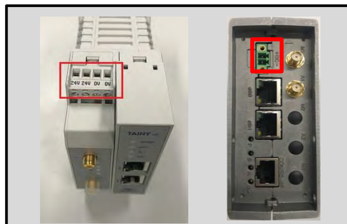
Abbildung 6: Router-Varianten "TAINY" (links) und "Garderos" (rechts) Anschluss für Spannungsversorgung
