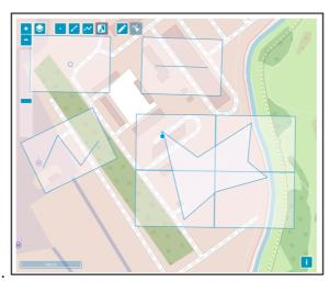
3. Wählen Sie Schaltfläche *Bearbeitung* , um die skizzierte Geometrie zu wählen, um sie zu verschieben oder mit der *Entf-*Taste zu löschen (in der folgenden Darstellung wurde die Geometrie verschoben).
